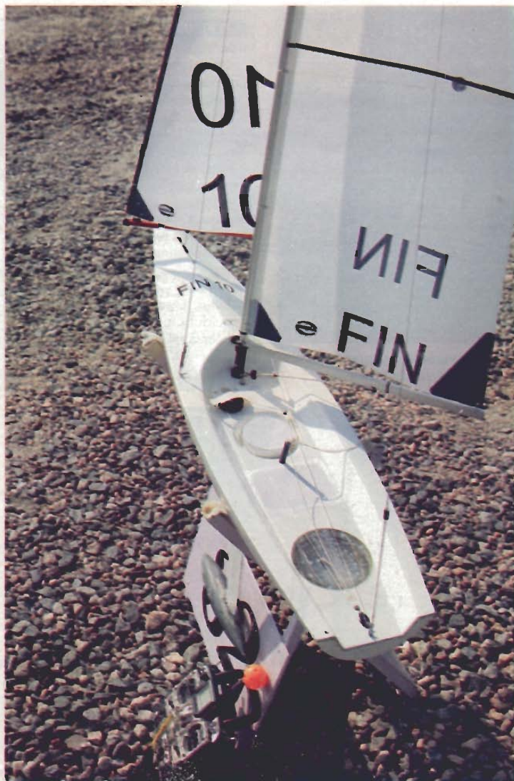
RADIO-OHJAIMESSA riittää kaksi kanavaa: toinen peräsimmelle ja toinen purjeiden säätöön. Varsinaiset trimmaukset on tehtävä maissa. Ohjausservo, purjevinssi ja radiolaitteet on sijoitettu vesitiiviisti kannen alle.
